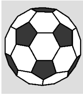
C_{60} , die 60 Kohlenstoffatome befinden sich in den Ecken dieses abgeschnittenen Ikosaeders
